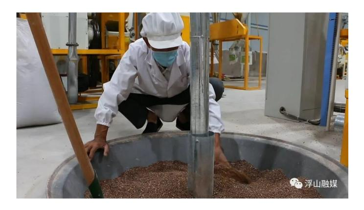
走进浮山县响水河镇东陈村石磨小杂粮加工坊,记者看到,工人师傅正忙着筛选、润麦、洗麦、研磨、装袋,机器的轰鸣声不绝于耳,车间里阵阵麦香扑鼻而来。
